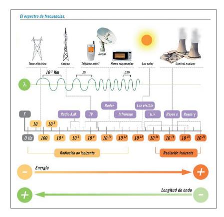
Figura 1. Diagrama esquemático del espectro electromagnético. (Cortesía Rafael Barzanallana, Univ. Murcia)
